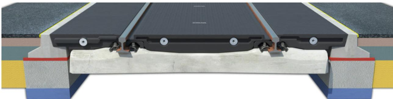
Figure 5 : coupe du platelage type Strail
