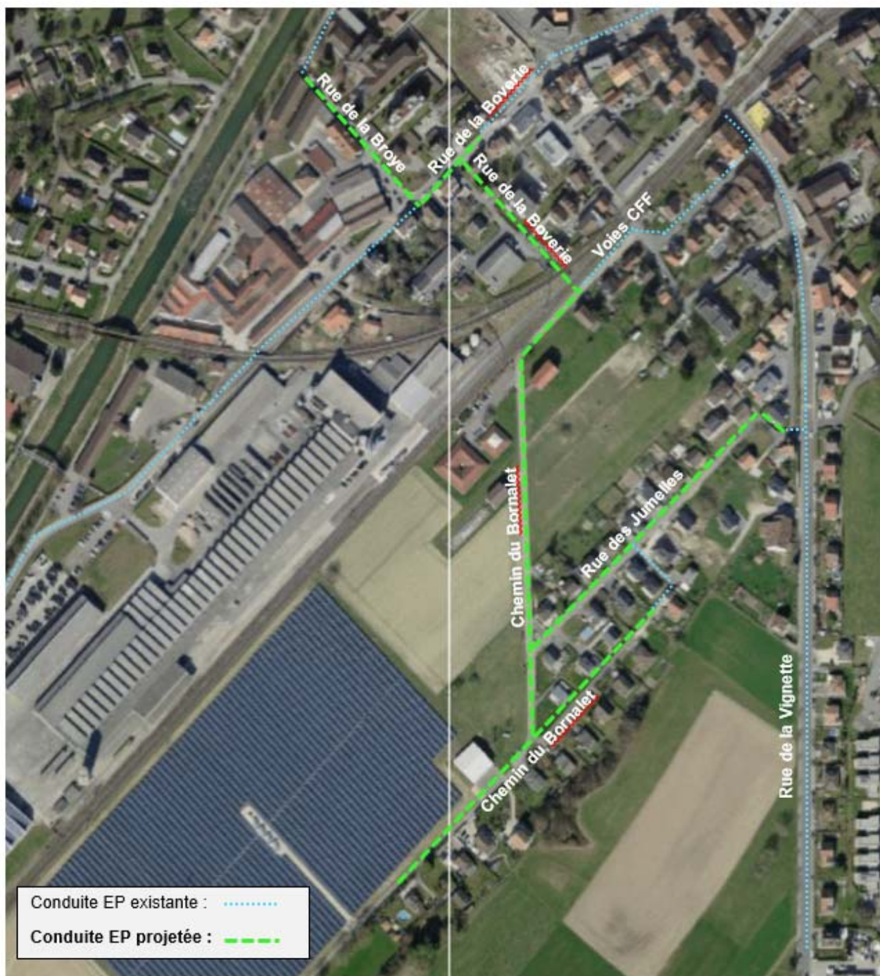
Figure 3 : Conduites EP à réaliser
