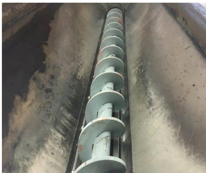
Remplacement du rotor du convoyeur pour le laveur de sable
