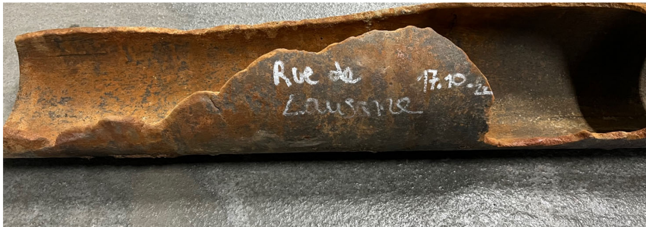
Figure 16 : Morceau de l'ancienne conduite d'eau en fonte grise
