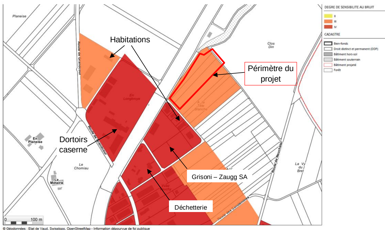
Figure 5-3 : Degré de sensibilité au bruit, sources et bâtiments sensibles à proximité du projet
