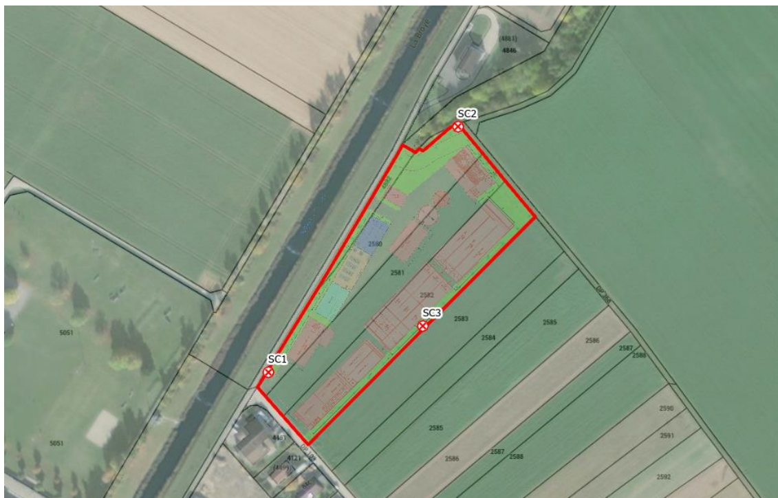
Figure 5-5 : emplacements des forages géotechniques d'investigation
