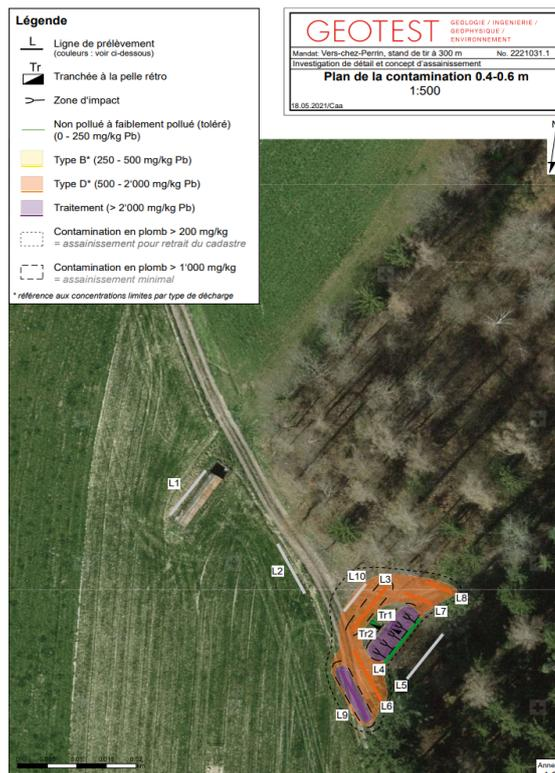
Plans des zones de contaminations selon la profondeur des prélèvements
